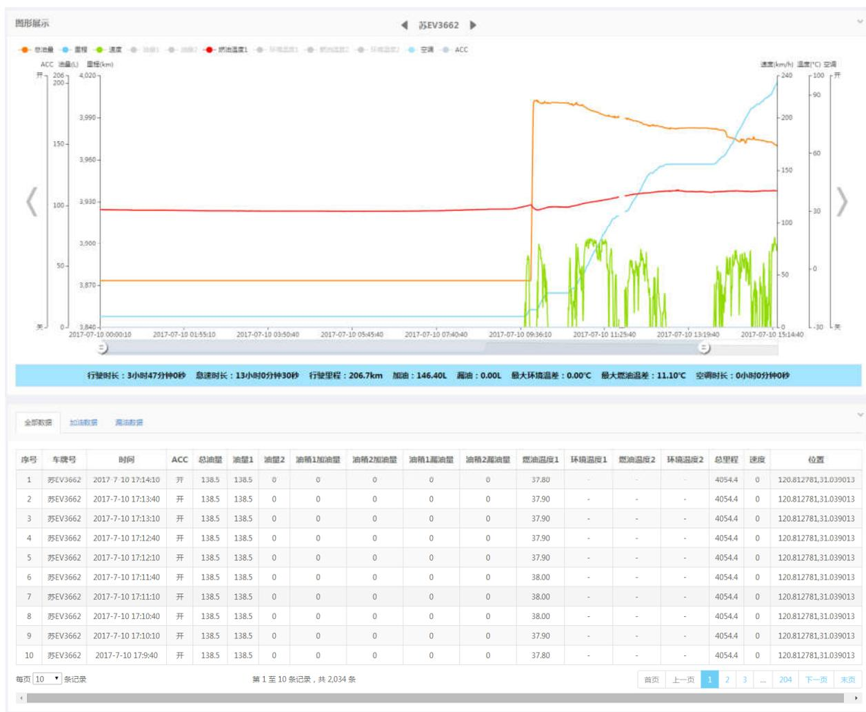
油量报表中的图形中，油量数据（曲线）、里程数据（曲线）、速度数据（曲线）以及燃油温度数据（曲线）、ACC 状态、空调状态等各数据的展示。便于更精准的掌握油量消耗状况。
