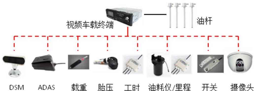
视频车载终端可以扩展的设备有：摄像头（专门接口）、DSM、ADAS、载重、油耗、
