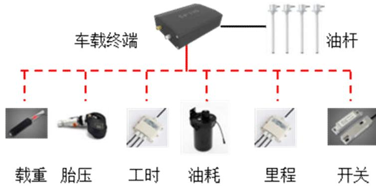
普通车载终端可以扩展的设备有：载重、油耗、里程、工时、胎压、开关量传感等。
